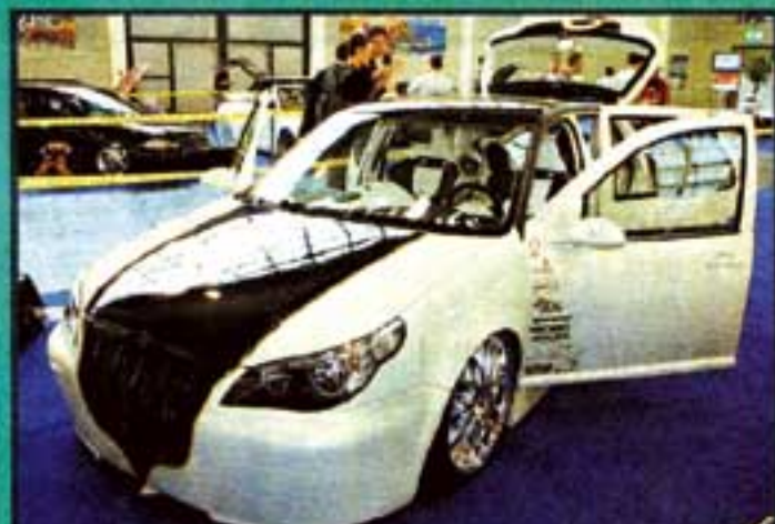
■由 Norman Hiller 改裝的福士 Golf 4 TDI 跑車，車身形態模仿寶馬跑車，車後座位由2減1，騰出空間放置賽車椅及音響系統。
